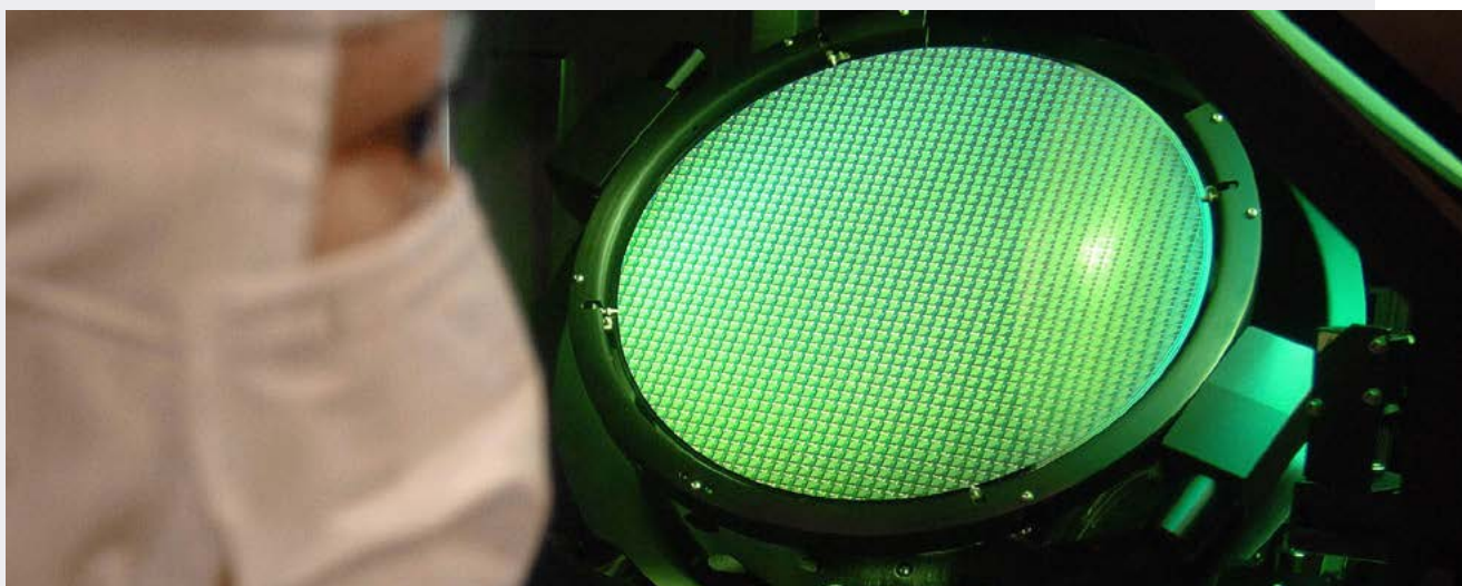
Un ingénieur examine une plaque de 12 pouces qui entre dans la fabrication de circuits intégrés. (Crédit : Sam Yeh, employé de Getty Images)
